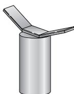
Zur leichteren Wartung wurde eine fahrbare Brennerstütze entwickelt. D.h. der Brenner kann ohne Gabelstapler demontiert werden. Distanzrohr zur bauseitigen Höhenanpassung ist bauseits zu stellen.
