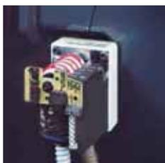
Bei Einsatz des Analog-Signalkonverters wird für dessen Betrieb ein Rückführpotentiometer benötigt. Soll zusätzlich eine Meldung über die Position des Stellmotors aus dem Brenner geführt werden, muss statt des einfachen Rückführpotentiometers ein Doppel-Potentiometer eingesetzt werden.
