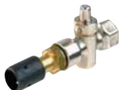
Prüfbrenner rückzündsicher zur Entlüftung der Gasstrecke. Stehender Einbau erforderlich. Ein Druckknopfahh ist vorzuschalten, wie auf der Abbildung zu sehen. (Druckknopfahh ist separat zu bestellen)
