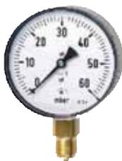
Kapsel federmanometer mit Stahlblechgehäuse 100 mm Durchmesser schwarz. Genauigkeitsklasse 1,6 gemäß EN 837-3/6, überlastsicher bis 1,3 x Skalenendwert. Zur Vermeidung ständiger Druckbelastung ist jeweils ein Druckknopfahh vorzuschalten.
