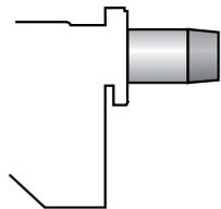
Für bestimmte Anwendungsfälle kann eine erhöhte Eintauchtiefe bzw. ein längeres Flammrohr erforderlich sein. Für diesen Bedarf stehen spezielle Bausätze zur Verlängerung des Flammrohres zur Verfügung.
