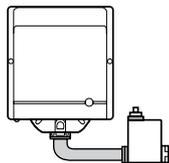
Falls der Brenner um 180° gedreht montiert wird, muss mit diesem Umstellsatz die korrekte Position der Gasventile wieder hergestellt werden.
