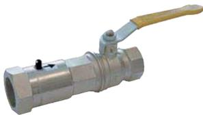
Mit thermisch auslösendem Sicherheitsventil. nach DIN 3357 zum Schutz im Brandfall. DVGW-geprüft.
