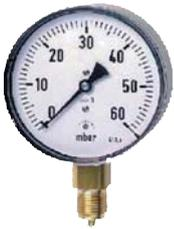
Kapselfederanometer mit Stahlblechgehäuse 100 mm Durchmesser schwarz. Genauigkeitsklasse 1,6 gemäß EN 837-3/6, überlastsicher bis 1,3 x Skalenendwert. Zur Vermeidung ständiger Druckbelastung ist jeweils ein Druckknopfahn vorzuschalten.
