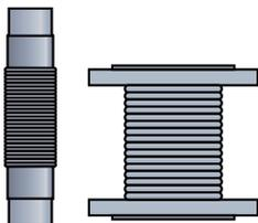
Axialkompensator aus Edelstahl zur Schwingungsentkopplung von Gasleitung und Brenner und zur Vereinfachung der Anschlussmontage.
