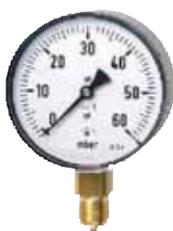
Kapsel federmanometer mit Stahlblechgehäuse 100 mm Durchmesser schwarz. Genauigkeitsklasse 1,6 gemäß EN 837-3/6, überlastsicher bis 1,3 x Skalenendwert. Zur Vermeidung ständiger Druckbelastung ist jeweils ein Druckknopfhahn vorzuschalten.
