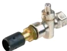
Prüfbrenner rückzündsicher zur Entlüftung der Gasstrecke. Stehender Einbau erforderlich. Ein Druckknopfhand ist vorzuschalten, wie auf der Abbildung zu sehen. (Druckknopfhand ist separat zu bestellen)
