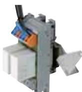
Für die Übertragung zweier zusätzlicher Signale vom Brenner, z.B. „Betrieb“ oder „Störung“ mittels potentialfreier Kontakte steht ein Einbausatz zur Verfügung. Vorkonfektioniert für RS 34-44/64 MZ. Frei einsetzbar für übrige RS Modelle.
