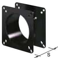
Sollte es notwendig sein, die Eintauchtiefe des Flammkopfes in die Brennerkammer zu reduzieren, stehen unterschiedlich starke Distanzflansche zur Verfügung.
