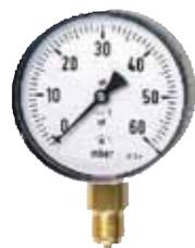
Kapselfederanometer mit Stahlblechgehäuse 100 mm Durchmesser schwarz. Genauigkeitsklasse 1,6 gemäß EN 837-3/6, überlastsicher bis 1,3 x Skalenendwert. Zur Vermeidung ständiger Druckbelastung ist jeweils ein Druckknopfhahn vorzuschalten.
