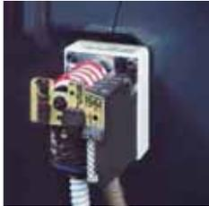
Bei Einsatz des Analog-Signalkonverters wird für dessen Betrieb ein Rückführpotentiometer benötigt. Soll eine Meldung über die Position des Stellmotors aus dem Brenner geführt werden, muss statt des einfachen Rückführpotentiometers ein Doppel-Potentiometer eingesetzt werden.
