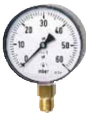
Kapselfedermanometer mit Stahlblechgehäuse 100 mm Durchmesser schwarz. Genauigkeitsklasse 1,6 gemäß EN 837-3/6, überlastsicher bis 1,3 x Skalenendwert. Zur Vermeidung ständiger Druckbelastung ist jeweils ein Druckknopfahn vorzuschalten.
