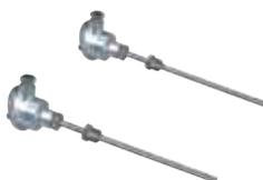
Der Einbausatz beinhaltet zwei Temperaturfühler: Einen für Luft- und einen für Abgastemperatur. Sie müssen an die Schnittstelle der Anzeige- und Bedieneinheit angeschlossen werden, damit die LMV 52-Berechnung des Wirkungsgrades durchgeführt werden kann. Der Wert wird am AZL-Display angezeigt.
