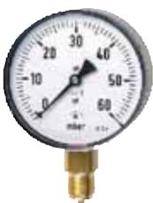
Kapselfederanometer mit Stahlblechgehäuse 100 mm Durchmesser schwarz. Genauigkeitsklasse 1,6 gemäß EN 837-3/6, überlastsicher bis 1,3 x Skalenendwert. Zur Vermeidung ständiger Druckbelastung ist jeweils ein Druckknopfhahn vorzuschalten.
