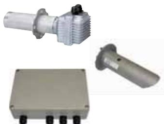
Die QGO<sub>2</sub> ist ein Sauerstoffanalysator mit entsprechendem Fühler, der den Restsauerstoffgehalt in den Abgasen regelt und überwacht. Bestehend aus Sonde, Tauchhülse und PLL-Elektronikmodul.
