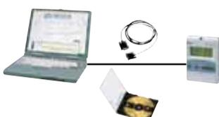
PC-Hilfsmittel zur bequemen Programmierung und Brennereinstellung, zur Prozess-Darstellung, zur Datenerfassung, zur Sprachauswahl des AZL, zur Aktualisierung der AZL-Software.
