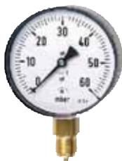
Kapsel federmanometer mit Stahlblechgehäuse 100 mm Durchmesser schwarz. Genauigkeitsklasse 1,6 gemäß EN 837-3/6, überlastsicher bis 1,3 x Skalenendwert. Zur Vermeidung ständiger Druckbelastung ist jeweils ein Druckknopfhahn vorzuschalten.
