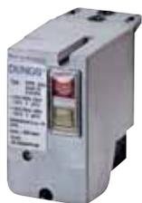
Um die Dichtheit der Ventile der Gasarmatur zu überprüfen, stehen je nach Gasarmatur entsprechende Nachrüstätze zur Verfügung. Die Ventildichtekontrolle ist an Gasarmaturen von Brennern mit der Höchstleistung über 1200 kW zwingend erforderlich (EN676). Alle Ventildichtekontrolle-Nachrüstätze verwenden die Ventildichtekontrolleinheit VPS 504.
